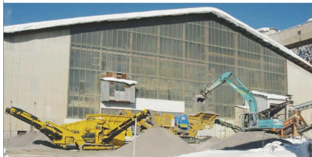
KEESTRACK-Hochleistungssiebanlage, mit OM Brechanlage ULISSE in Verbindung
